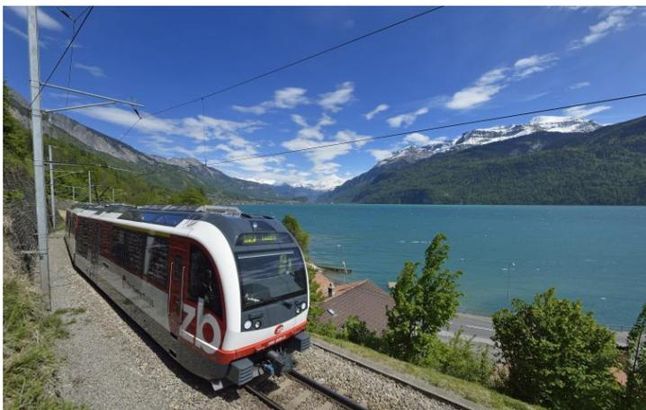
Er ist SIEBENTEILIG, bestehend aus 2 DREITEILIGEN TRIEBMODULEN mit je einem FÜHRERSTAND und einem dazwischen eingereihten BLSTROWAGEN. Die ZENTRALBAHN besitzt 4 dieser ca. **200 TONNEN** schweren ZÜGE, welche **126m** LANG sind und **307 SITZPLÄTZE** (davon **74** in der 1. KLASSE) anbieten.
