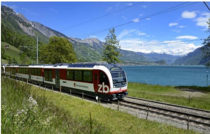
Die DREITEILIGEN **FINKen** (Flinke, Innovative, **Niederflur**, **Komposition**) dienen als VERSTÄRKUNGSMODULE der siebenteiligen „IR“ ZÜGE „ADLER“ und können auch in der **S4** der **S5** in der REGIO INTELAKENMEIRINGEN und als zusätzliche ENTLASTUNGSZÜGE **S44** und **S55** eingesetzt werden. Sie bieten auf **54m LÄNGE**, **139 SITZPLÄTZE** (davon **18** in der 1. KLASSE) an. Das
